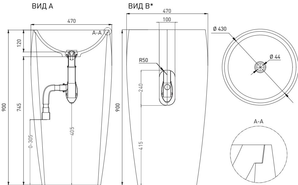
\* Расположение стандартного технического отверстия на задней стенке. В базовую комплектацию не входит, заказывается отдельно.
